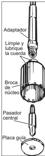
Los trépanos para paredes delgadas para servicio pesado de MILWAUKEE taldran orificios de hasta 76 mm (3") de profundidad. Para taladrar orificios más profundos, extraiga la broca, rompa y extraiga el trépano. Continúe taladrando.
