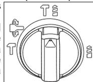
2. Para martilleo rotatorio, presione el botón y gire la palanca de selector de manera que la flecha apunte hacia el símbolo del martillo y de broca helicoidal
