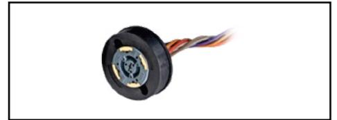
Base para fotocelda de control NEMA, compatible con atenuación conforme a ANSI C136.41. Con 7 pines: 3 de alimentación y 4 de atenuación. Preparada para conexión de sistema de telegestión.
