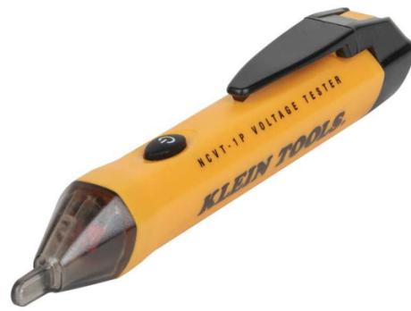
El probador de voltaje sin contacto de Klein Tools detecta voltaje estándar en cables, cables conductores, cortacircuitos, accesorios de iluminación, interruptores, tomacorrientes no inviolables y alambres. Un LED de color verde brillante de gran intensidad que indica que el probador está encendido. Cambia a color rojo y emite tonos audibles cuando detecta voltaje.
