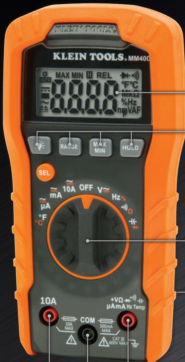
Conectores de entrada de cables de prueba
