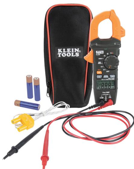
El CL220 mide corriente CA y NCVT con unas pinzas, así como voltaje CA/CD, resistencia y continuidad con cables de prueba, y la temperatura con un termopar. El multímetro cuenta con tecnología de medición de rango automático con media cuadrática real (TRMS) que ofrece mayor precisión. Además, una pantalla LCD retroiluminada facilita la visualización en lugares con poca luz.
