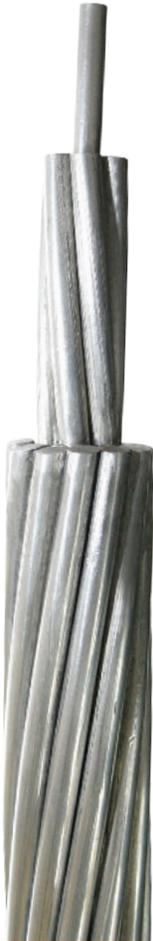
Los cables tipo AAC (All Aluminum Conductor), están formados a partir de aluminio obtenido por refinación electrolítica con pureza de 99,5 % y conductividad mínima de 61,0 %, de la conductividad del cobre a 20°C (IACS) "International Annealed Copper Standard". Todos los cables están formados por hilos de aluminio duro cableados concéntricamente.
