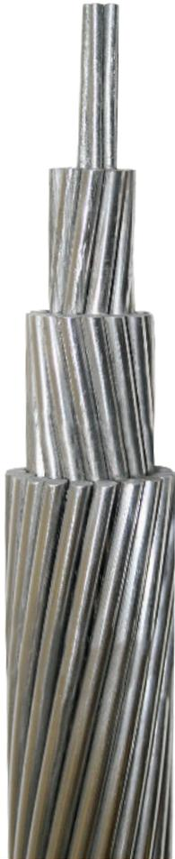
Los cables tipo ACSR (Aluminum Conductors Steel Reinforced), están formados a partir de aluminio obtenido por refinación electrolítica con pureza de 99,5 % y conductividad mínima de 61,0 % de la conductividad del cobre a 20°C (IACS) "International Annealed Copper Standard", todos los cables están formados por alambres de temple duro, cableados concéntricamente sobre un núcleo de acero galvanizado.
