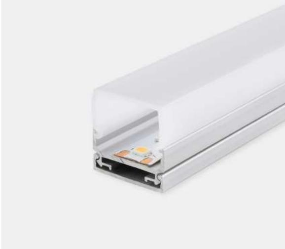
Perfil metálico para sobrepoder con óptica de policarbonato para alojar tira de LED de hasta 10 milímetros de ancho. Cuerpo de aluminio con acabado anodizado.
